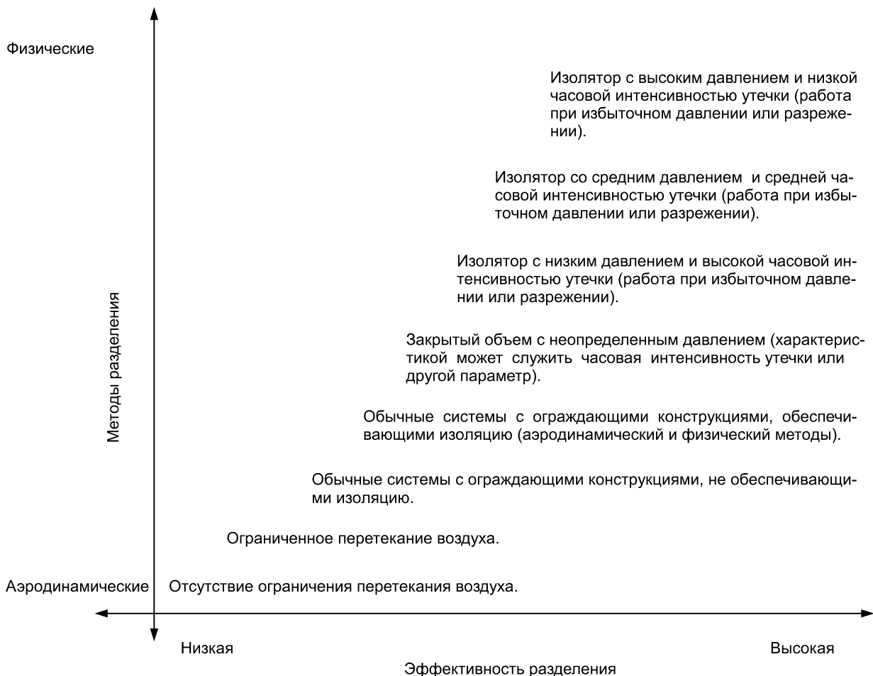
Рисунок А.1 — Иллюстрация эффективности разделения (изоляции) в зависимости от используемых методов (от аэродинамических до физических); сдвиг на схеме показывает приблизительную характеристику эффективности
